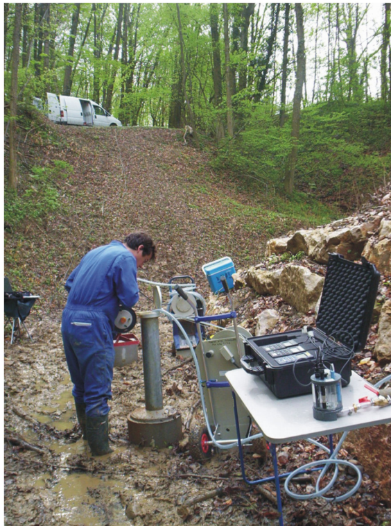
Protocole opératoire des prélèvements des eaux souterraines. Aperçu photographique
